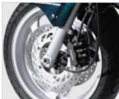
Das neue CBS Bremssystem sorgt bei Fußbremsung für optimale Bremswirkung auf Vorder- und Hinterrad.
